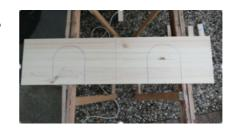
3. Jetzt mit der Stichsäge aussägen und mit dem Schleifpapier bearbeiten.
